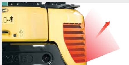
Emisja powietrza chłodzącego silnik skierowana ku górze (ochrona ludzi i roślin z otoczenia)
