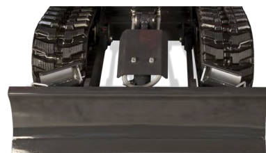
Podwozie wsunięte: 955 mm
