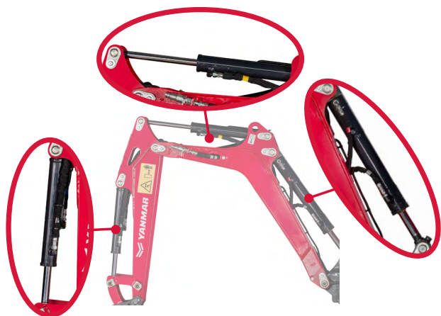
Siłowniki zamontowane nad wysięgnikiem
